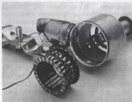
Fig. 7. Particolari della dinamo, modificata per la versione 1 del trasduttore della direzione del vento.
