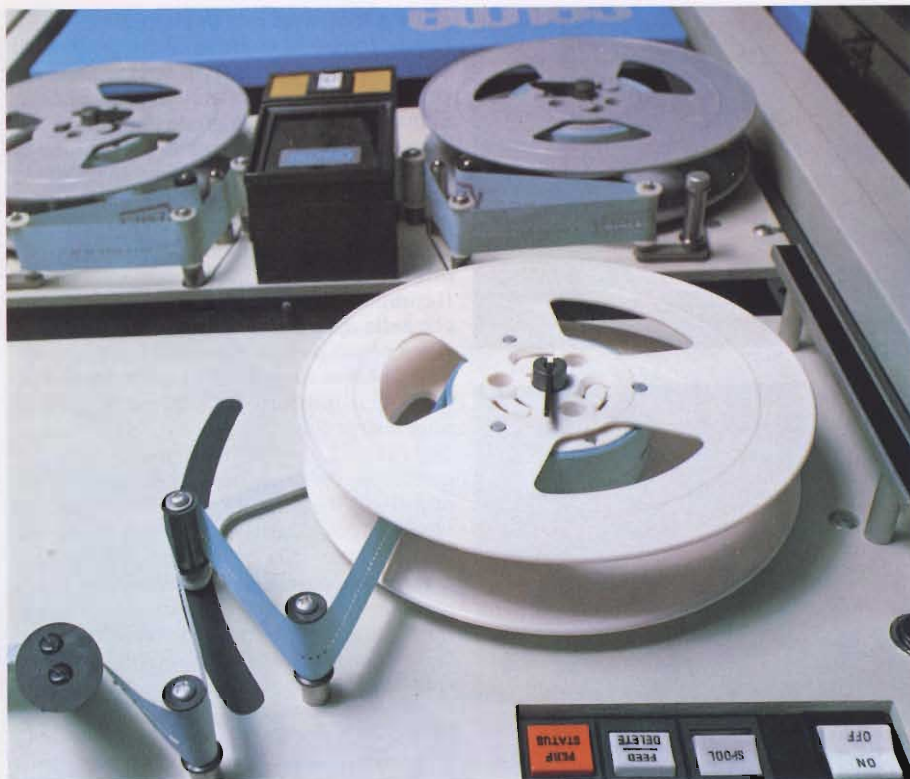
La preparazione dei nastri per le macchine a controllo numerico. I tempi di realizzazione con tale sistema si riducono rispetto a quelli tradizionali di 1/3 (fino al 1/10).
